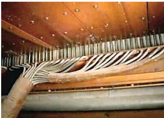
A la izquierda, Prosper-Antoine Moitessier (Carcassonne, 1807 – Montpellier, 1867); a la derecha, detalle de los tubos de transmisión de aire en la parte interior de una consola
